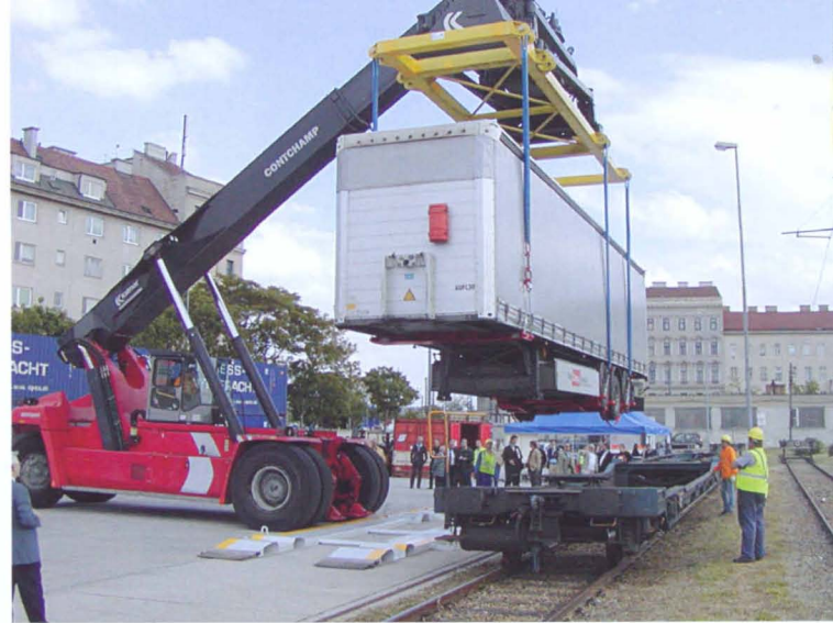
Die Demonstration der entwickelten ISU-Technik für den intermodalen Transport für nicht-kranbare Anhänger ist für September 2009 geplant Foto: HaCon
